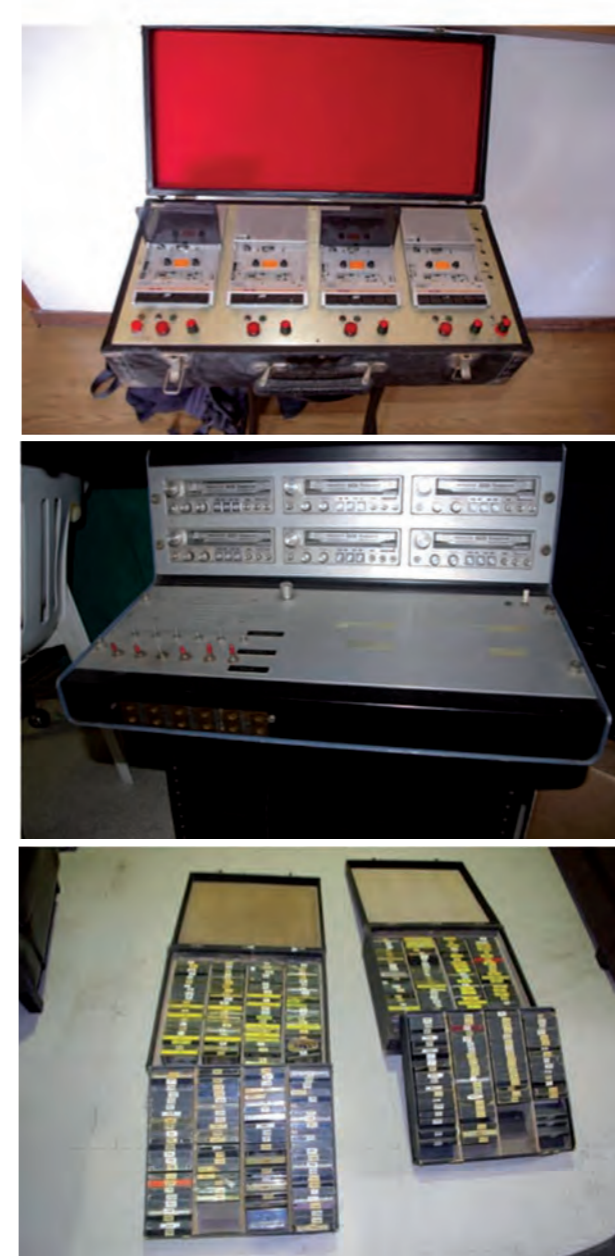
Fig. 13. Lettore di basette 4-deck risalente ai primi anni '70, costruito da Mario Lupi per la Anzellotti Sound Effects (si tratta di un modello molto simile ai primi prototipi costruiti). 13-II. Lettore di basette 6-deck risalente agli anni '80 costruito per conto di Italo Cameracanna. 13-III: Due valigie del più vasto repertorio di ambienti ritrascritti su nastro da 1/8 ", appartenute a Renato Marinelli (per gentile concessione di I: Massimo e Luciano Anzellotti; II: Italo Cameracanna, III: Marco e Massimo Marinelli).
